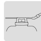
Tapa con broches para sujetar la pipeta
